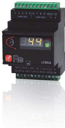
Lybra è un amplificatore digitale della tensione del laminato rilevata dalle celle di carico. È dotato di soli 3 pulsanti per la calibrazione e la programmazione e di un display a 3 digit che visualizza la funzione selezionata ed il valore impostato.
