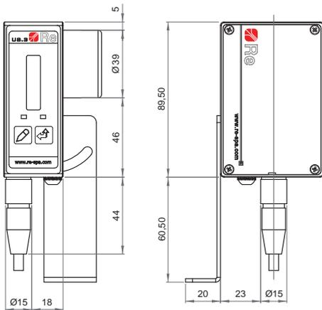
US.3 è un sensore ad ultrasuoni ideato principalmente per il controllo del tiro del materiale nei sistemi a loop aperto.
